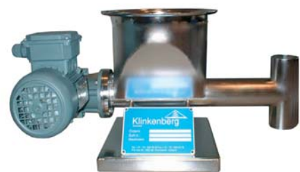
Volumetrisch doseerschroefje voor het doseren van granulaat, geplaatst op weegschaal.
